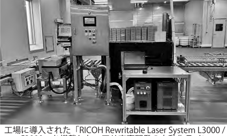
工場に導入された「RICOH Rewritable Laser System L3000/C3000」を搭載したユアサ商事開発の自動化ライン
